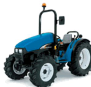
Slika 2. Zaštitna struktura ravanskog tipa ispred položaja rukovaoca
