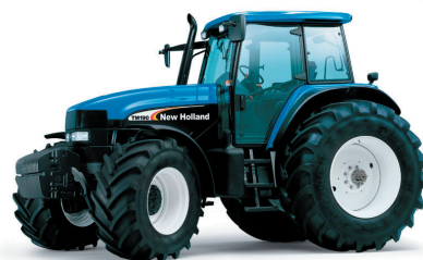
Slika 5. Kabina sa šest vertikalnih nosača
