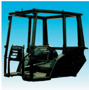
Slika 4. Zaštitna struktura sa šest nosača
