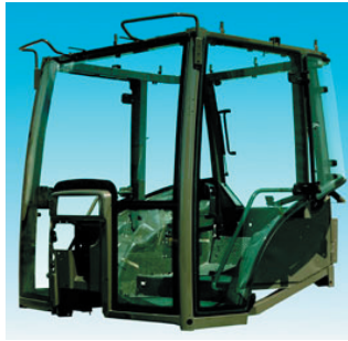
Slika 3. Zaštitna struktura sa četiri nosača
