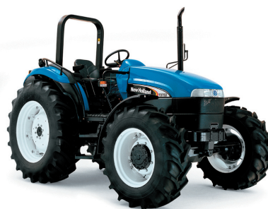
Slika 1. Zaštitna struktura ravanskog tipa iza položaja rukovaoca
