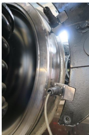
Слика 32. Мерење силе притиска кочне папуче на точак - давачи силе FB50
