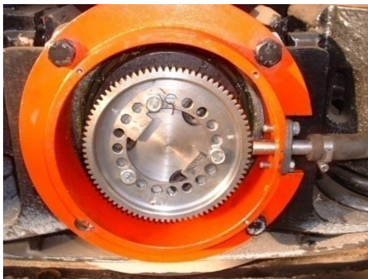
Слика 12. Индуктивни давач броја обртаја
