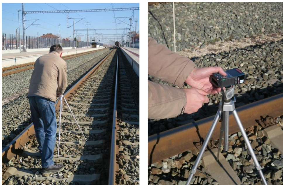
Слика 15. Калибрација радара и оптичког давача помоћу ласерског даљиномера
