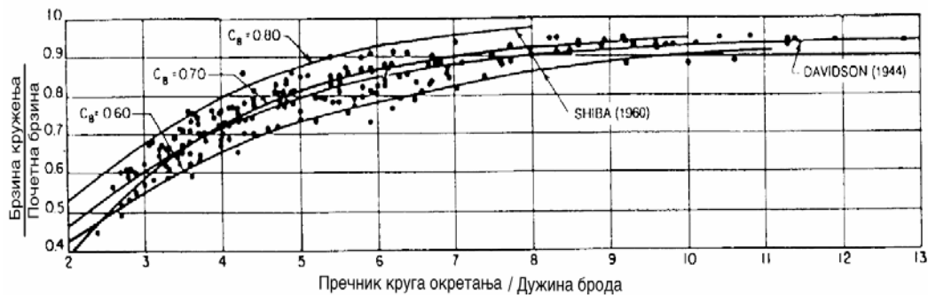
Слика 9.1 – Пад брзине при скретању брода [5]
