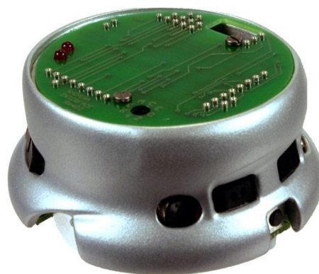
Слика 8.8: Основна конфигурација Khepera II мобилног робота (URL7)
