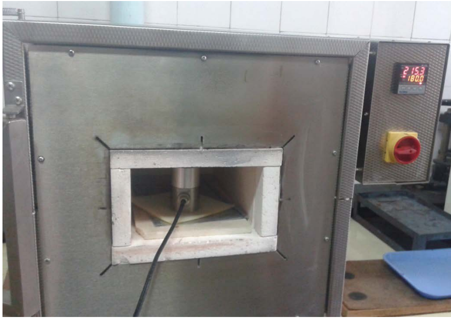
Слика 44. Мерење топлотне проводљивости парафина Е53
