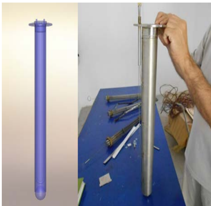
Слика 54. Модел и изведено стање склопа чауре и грејача
