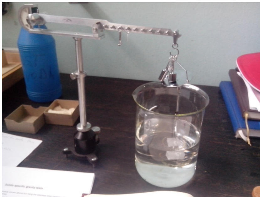
Слика 40. Мерење густине чврсте фазе парафина помоћу Морове ваге
