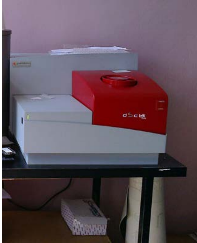
Слика 47. Уређај за мерење топлоте промене фазе и специфичног топлотног капацитета DSC EVO 131
