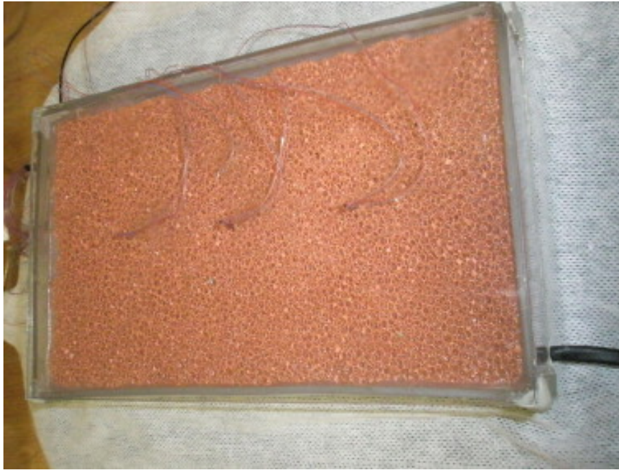
Слика 19. Бакарна кошуљица испуњена парафином [78]
