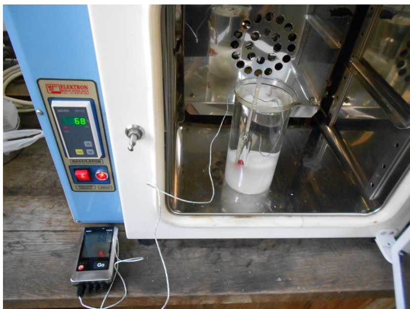
Слика 41. Мерење густине течне фазе парафина
