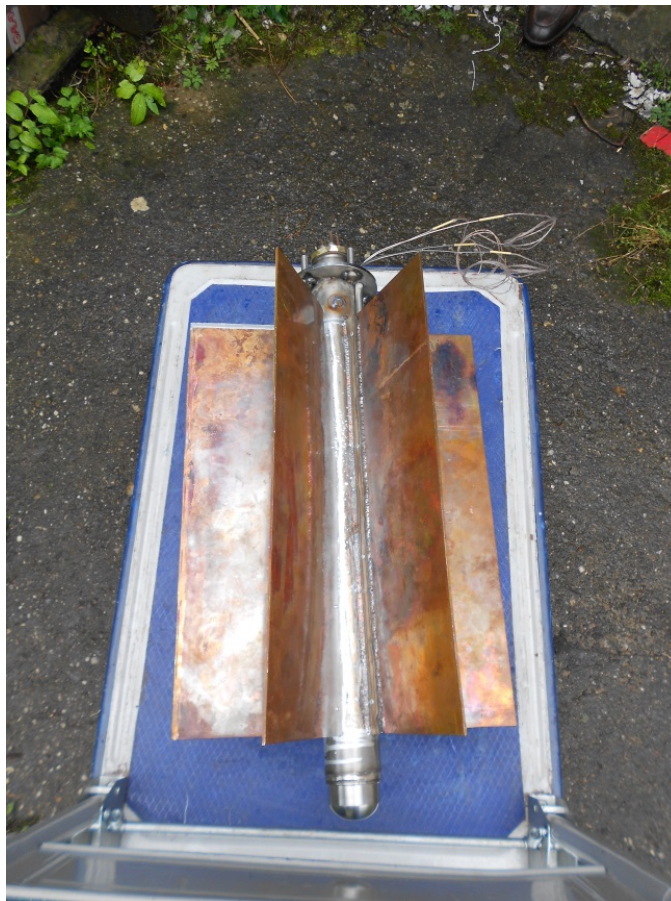
Слика 55. Изглед склопа електричног грејача и чауре са 6 подужних бакарних ребара
