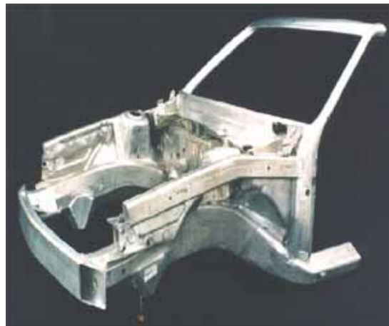
Slika 6. Volvo koncept strukture od aluminijuma izrađene hidroformingom,
