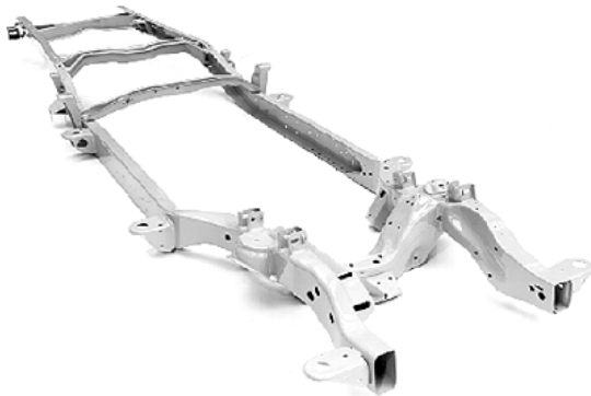
Slika 7. Šasija lakog kamiona od hidroformiranih komponenti
