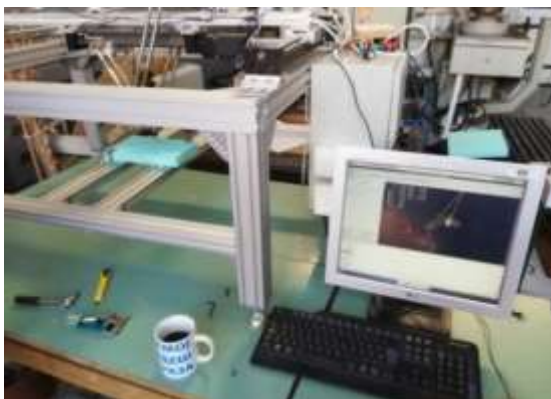
a) edukaciona mašina alatka sa hibridnom kinematikom u ukrštenoj X konfiguraciji
