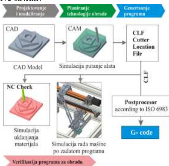
Slika 6 - Osnovna struktura sistema za programiranje
