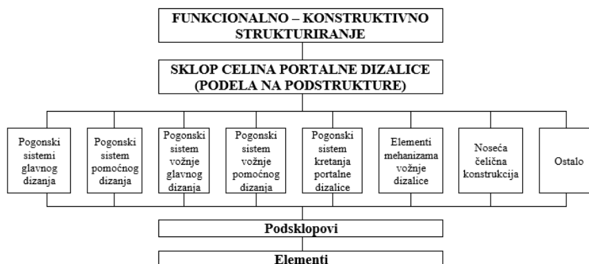
Slika 1 - Podela sistema portalne dizalice na podstrukture [2]
