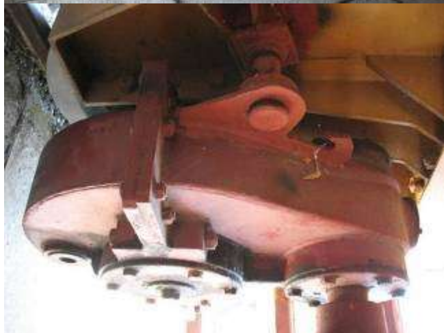
Slika 4.2.3.1 Vizuelna kontrola stanja elemenata pogonskih mehanizama za vožnju čistilica
