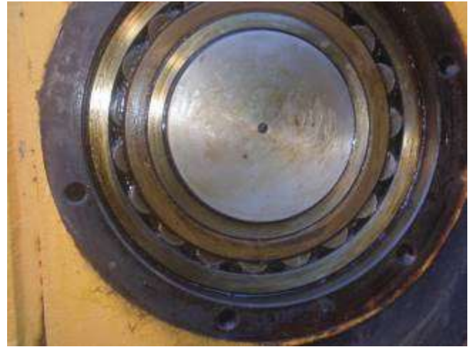
Slika 4.1.4.4 Kontrola ležajeva točkova
