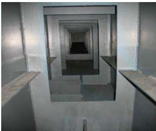
Slika 4.1.5.2 Unutrašnjost glavnih nosača portalnih dizalica
