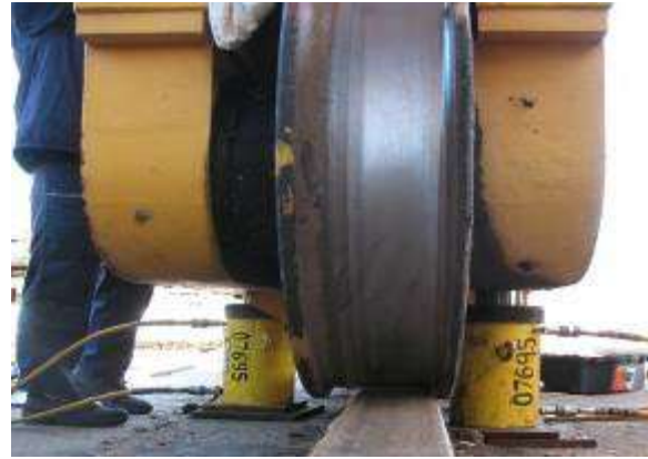
Slika 4.1.4.5 Merenje opterećenja točkova
