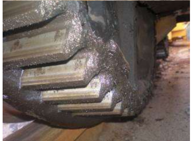
Slika 4.1.4.1 Stanje karakterističnih elemenata mehanizama kretanja rečne i obalne portalne dizalice
