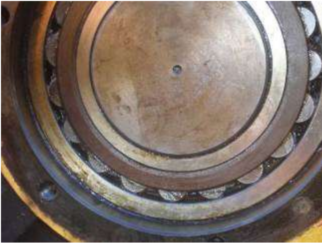
Slika 4.1.4.4 Kontrola ležajeva točkova
