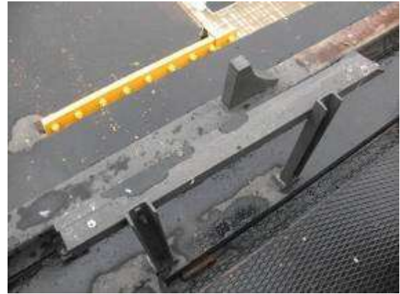
Slika 4.1.5.3 Šina na glavnom nosaču, poprečni vezni nosač dva glavna nosača i gazišta
