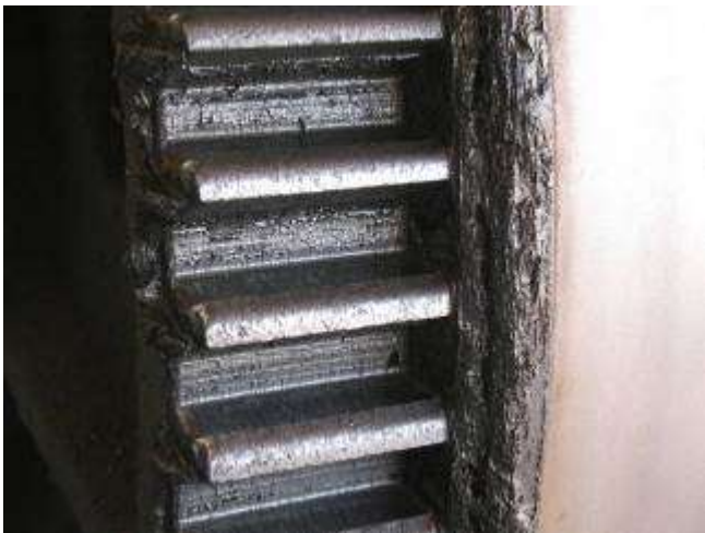
Slika 4.1.4.6 Pohabanost dva pogonska zupčanika na rečnoj dizalici, nizvodna obalna strana
