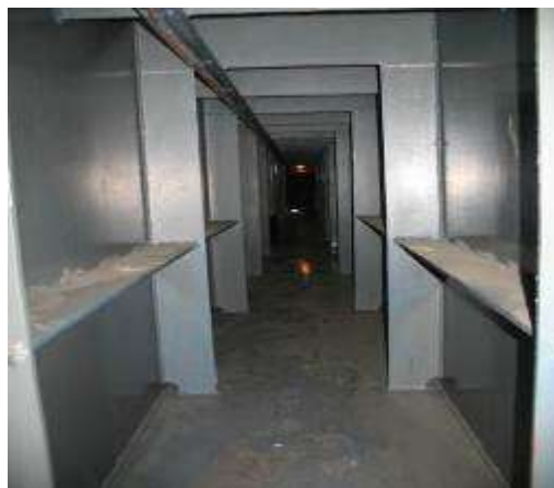
Slika 4.1.5.2 Unutrašnjost glavnih nosača portalnih dizalica
