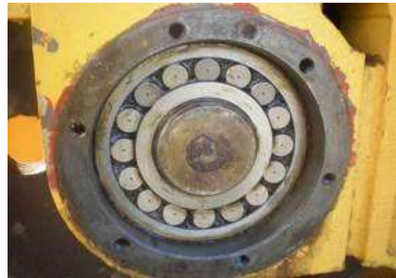
Slika 4.1.3.2 Kontrola ležajeva točkova kolica rečne i obalne dizalice
