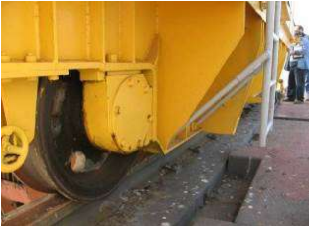
Slika 4.1.3.1 Stanje karakterističnih elemenata mehanizama kretanja kolica obe portalne dizalice
