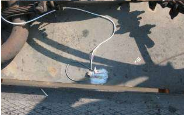
Slika 4.2.6.1 Merna oprema, merna mesta MM0, MM1, MM2 i MM3
