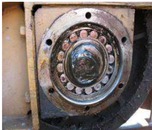
Slika 4.2.3.3 Provera ležajeva točkova
