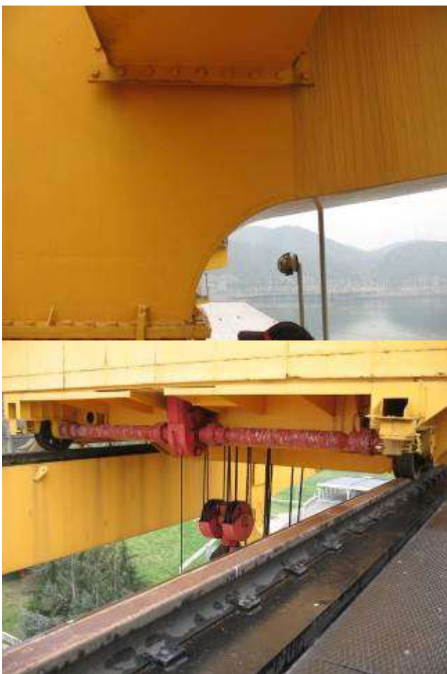
Slika 4.1.5.4. Veze poprečnih nosača sa glavnim nosačima i veza glavnih nosača sa nogama dizalica
