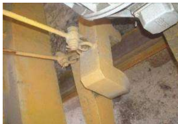
Slika 4.1.4.12 Kočioni sistem – klješta za parkiranje dizalice
