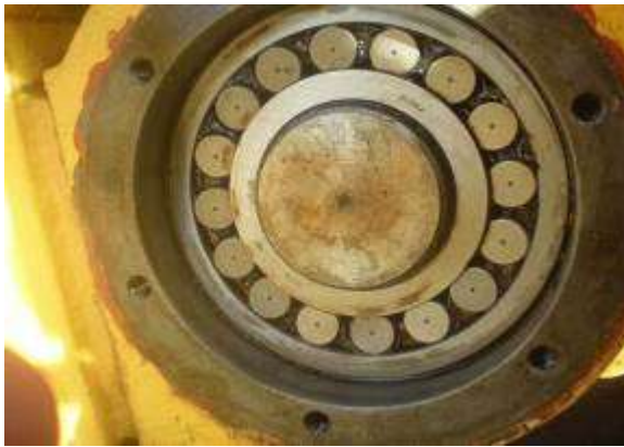
Slika 4.1.3.2 Kontrola ležajeva točkova kolica rečne i obalne dizalice
