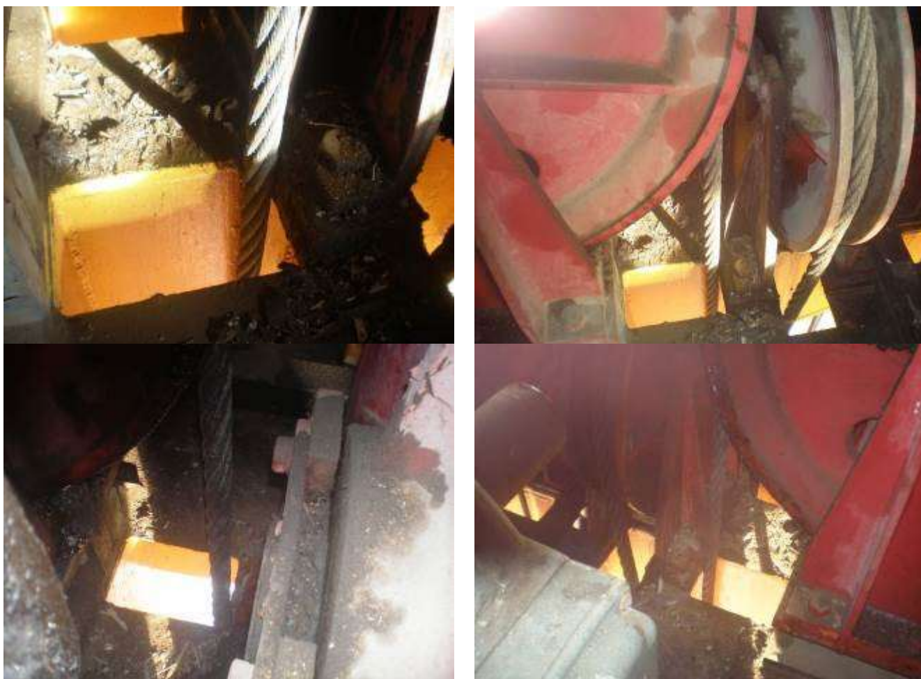
Slika 4.1.3.3 Habanje (dodirivanje) užeta o konstrukciju poda kućice
