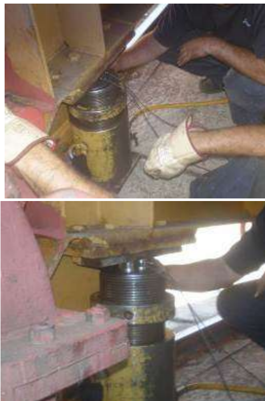
Slika 4.2.3.4 Merenje opterećenja točkova
