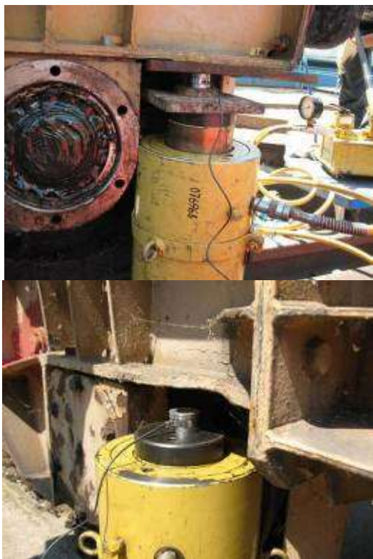
Slika 4.2.3.4 Merenje opterećenja točkova
