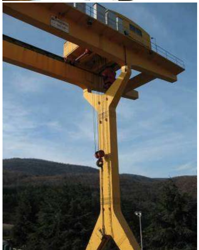
Slika 4.1.7.2 Stanje konstrukcije zglobnih nogu rečne i obalne portalne dizalice
