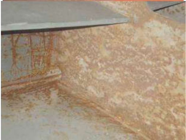
Slika 4.1.6.3 Stanje konstrukcije krute noge na mestu veze "d" iznutra, obalna dizalica
