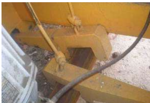
Slika 4.1.4.12 Kočioni sistem – klješta za parkiranje dizalice
