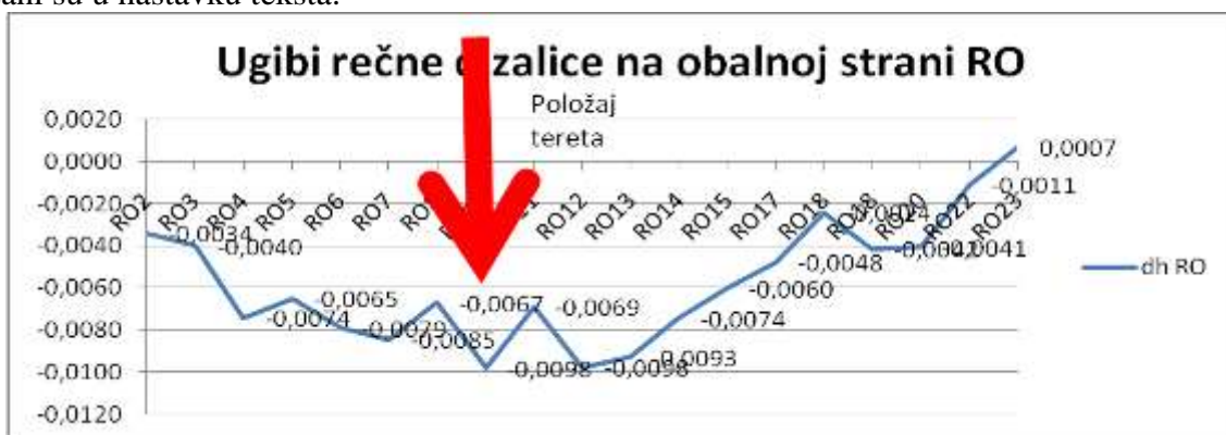
Slika 4.1.10.14 dijagram ugiba obalne strane rečne dizalice
