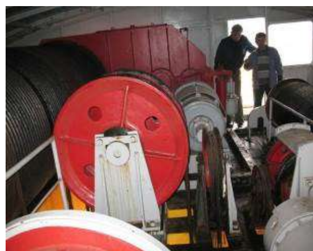
Slika 4.1.1.1 Stanje karakterističnih elemenata mehanizama glavnog dizanja obe portalne dizalice
