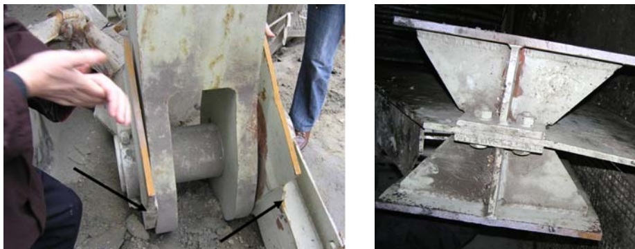
Figure 2. Fracture of two lugs on the counterweight holder. Slika 2. Lom dveju uški na držaču protivtega
