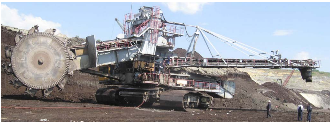
Figure 9. BWE C700S after reconstruction with added new tension rods. Slika 9. BWE C700S posle rekonstrukcije sa dodatnim novim zategnutim elementima (štapovima)
