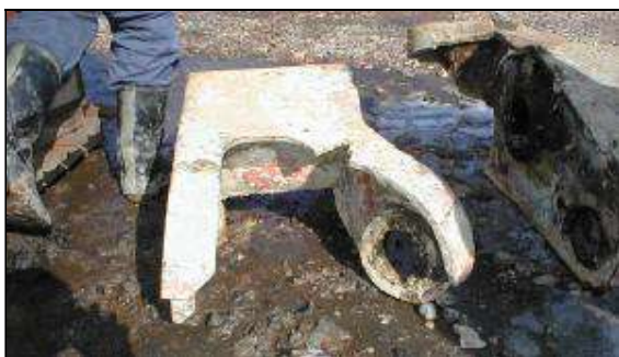
Slika 3 – Havarisano telo dvotočkovnih kolica
