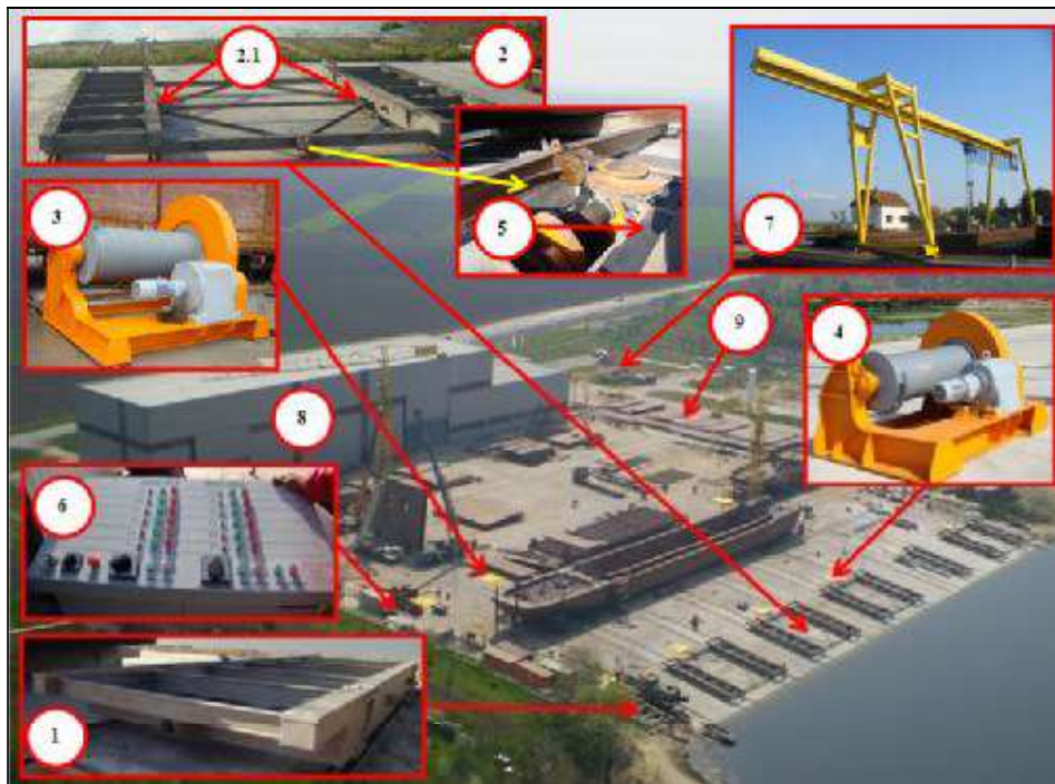
Slika 24 – Osnovni funkcionalni elementi mehanizovanog navoza: 1 – kolica nosivosti 300 t; 2 – tandem kolica nosivosti 2 x 150 t; 3 – vitlo maksimalne vučne sile 282 kN („veliko vitlo“); 4 – vitlo maksimalne vučne sile 75.5 kN („malo vitlo“); 5 – rolne za vođenje i usmeravanje užadi; 6 – upravljački pult; 7 – portalna dizalica nosivosti 10 t, raspona 17 + 8 m; 8 – proizvodna hala; 9 – otvoreno skladište limova [16]
