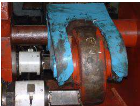
Slika 14 – Plastične deformacije i lom viljuške originalnih dvotočkovnih kolica tokom ispitivanja
