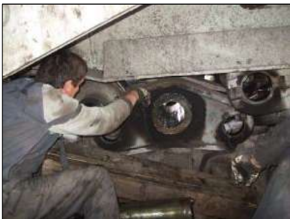
Slika 4 – Demontaža oštećenog tela dvotočkovnih kolica
