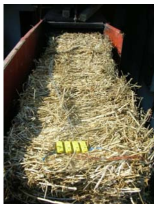
Sl. 3. Fotografija termoparova na bali u sistemu za doziranje Fig. 3. Photo of thermocouples on the bale in feeding system
