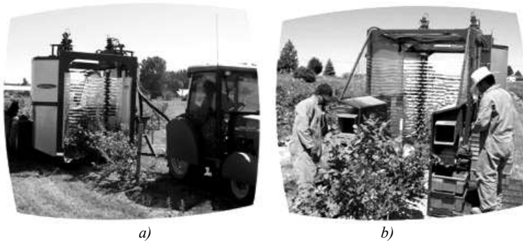
Sl. 8. Mašina za branje malina i borovnica "Korvan" 930 a) prednji izgled i priključivanje za traktor; b) zadnji izgled
