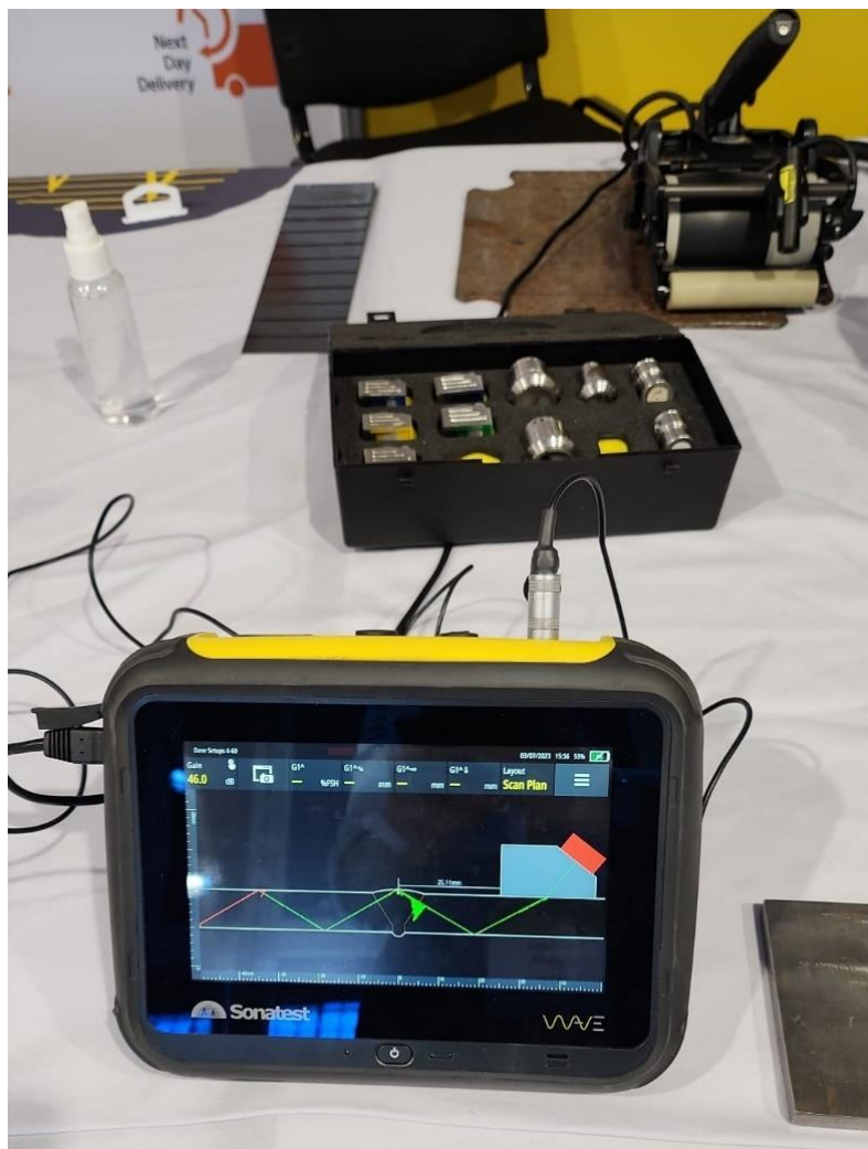
Slika 8. Savremeni ultrazvučni aparat; model: Wave; proizvođač: Sonatest
