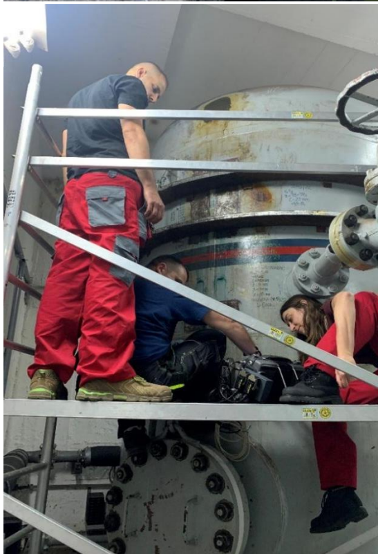
Slika 26(b). Ispitvanje SP 970 naprednim metoda PAUT i ToFD; Ispitivači: Milan Kozlovački (Zavod za zavarivanje), Stefan Kutlača (Trokut Test), Mirjana – F. Opačić (Innovacion Centar Mašinski Fakultete UB); uređaj: Sonatest Veo +
