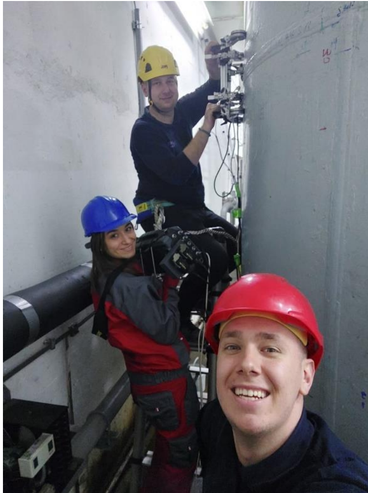
Slika 26(a). Ispitvanje SP 970 naprednim metoda PAUT i ToFD; Ispitivači: Filip Pavlović, Miloš Pantelić (IMW Institut – Kragujevac), Mirjana – F. Opačić (Inovacion Centar Mašinski Fakultete UB); uređaj: Sonatest Veo +
