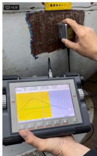
Fotografija broj 13-Indikacija 1.3-Rezultat ispitivanja-Zona maksimalnog ehoa
