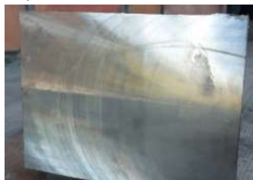
Slika 6a - Presek zavarenog spoja (nenagrižen uzorak)
