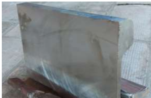
Slika 7 - Uzdužni presek kroz središnju liniju zavarenog spoja vrha stope šine
