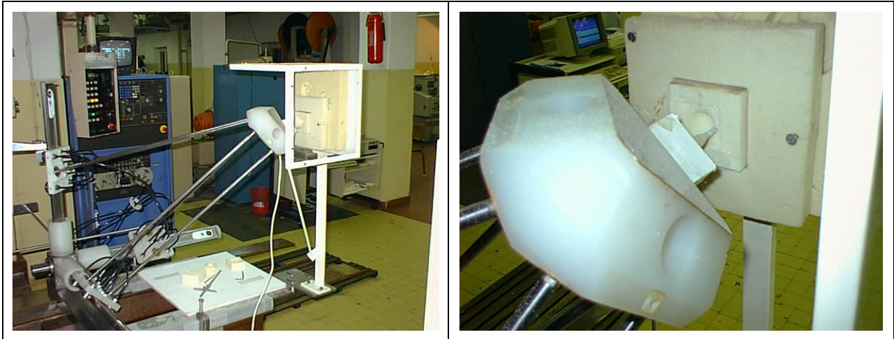
Slika 7. Primer obrade dela primenom CAD/CAM na P3
