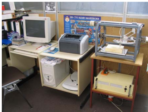
Slika 9. Radno okruženje za edukacionu troosnu mašinu sa paralelnom kinematikom pn101
