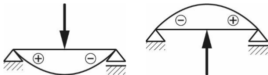
Слика 4.38 Предзнак за нагибе \alpha и \beta на еластичној линији савијене греде под дејством силе
