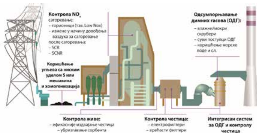
Слика 38. Типични системи за смањење емисије у термоелектранама [1]
