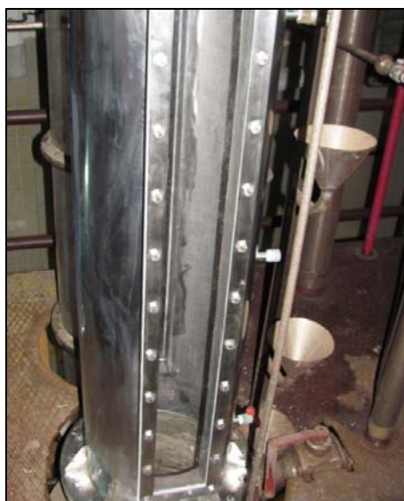
Slika 5. Tipične sekcije opitnih kolona izrađene na osnovu 3D modela
