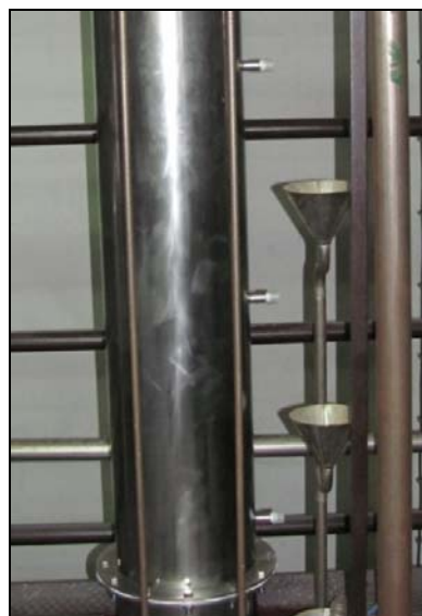
Slika 5. Tipične sekcije opitnih kolona izrađene na osnovu 3D modela
