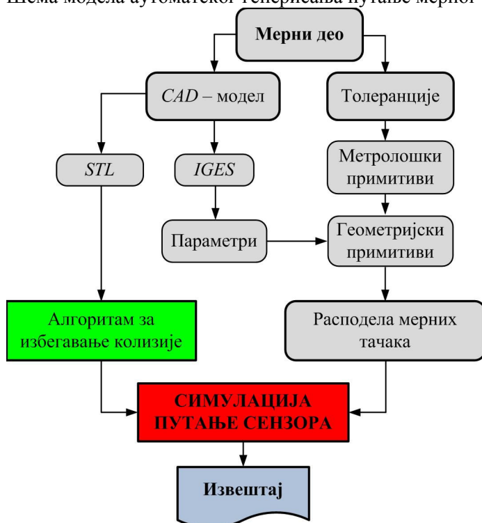
Слика 1. Планирање путање мерног сензора
