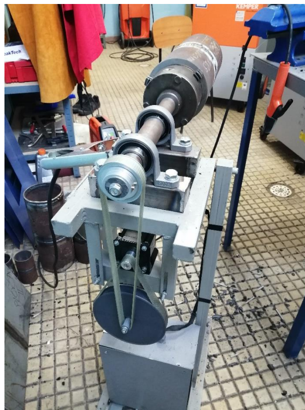
Слика 12. Изглед уређаја за постизање константне брзине обртања цеви при заваривању
