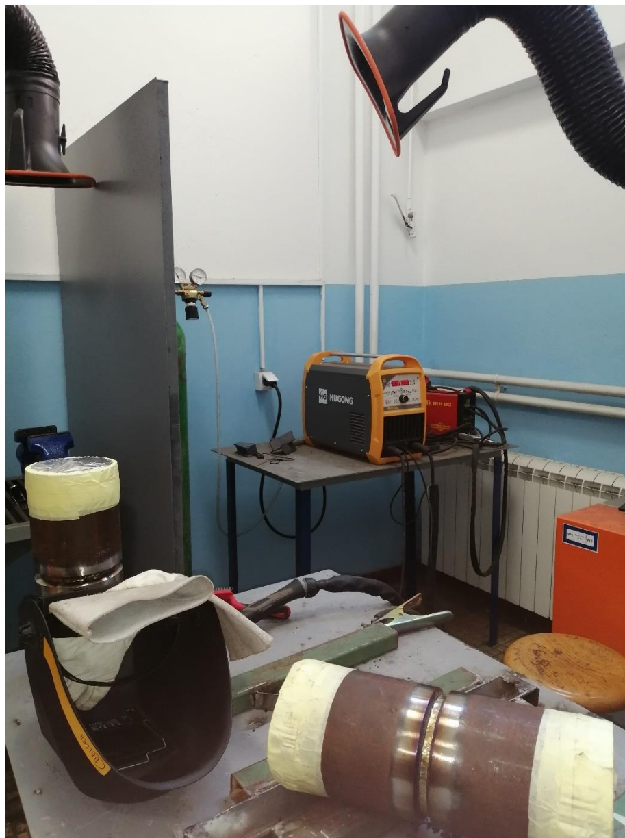
Слика 13. Изглед цеви након TIG заваривања кореног и другог пролаза
