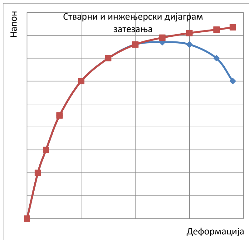
Слика 7. УПОРЕДНИ ДИЈАГРАМ ЗАТЕЗАЊА – СТВАРНИ И ИНЖЕЊЕРСКИ
