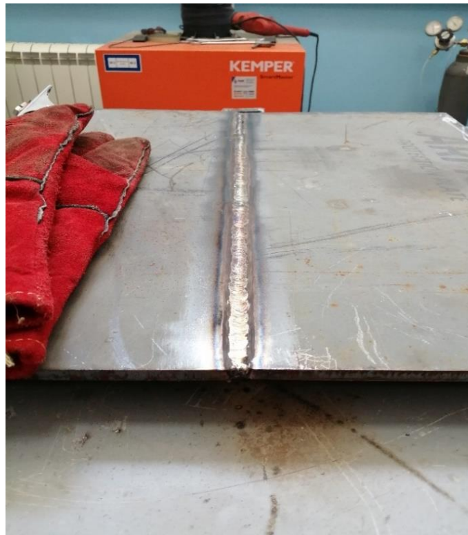
СЛИКА 14. ИЗГЛЕД ЗАВРШНОГ ПРОЛАЗА НА ПЛОЧИ ARMOX 500T
