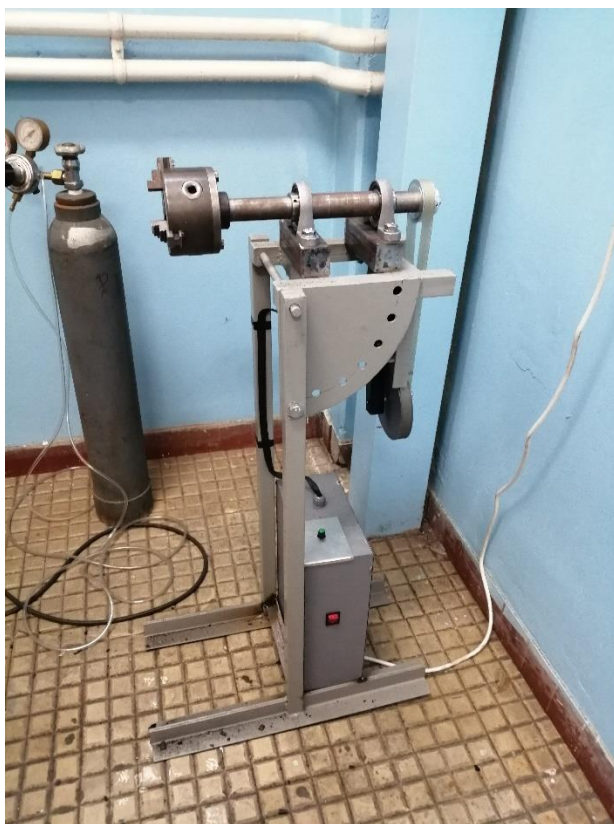
Слика 12. Изглед уређаја за постизање константне брзине обртања цеви при заваривању
