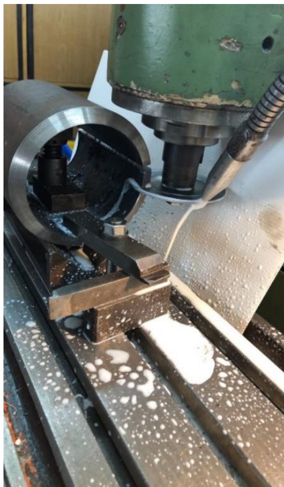
Слика 17. ИСЕЦАЊЕ ЕПРУВЕТА ИЗ ЦЕВИ УЗ ХЛАЂЕЊЕ
