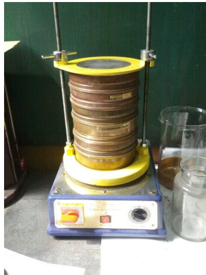
Slika 2. Aparatura za određivanje granulometrijskog sastava pepela pomoću sita
