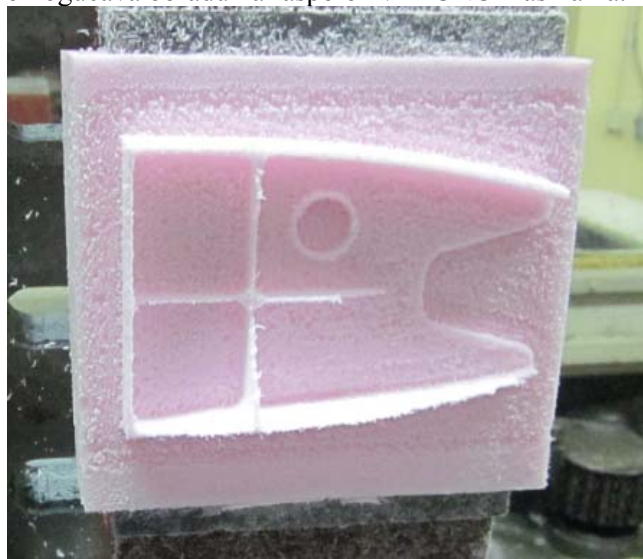
Slika 6. Deo dobijen obradom na bazi STEP-NC programa prevedenog na G kôd
