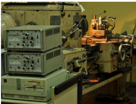
Слика 3.4: Универзални струг са уређајима за аквизицију
