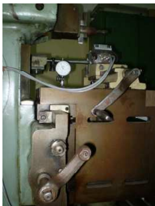
Слика 3.3: Хоризонтална рендисалка
