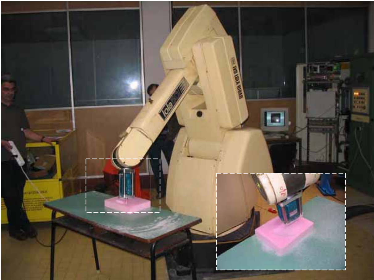
Слика 7. Пилот реконфигурабилног мултифункционалног обрадног система на бази робота
