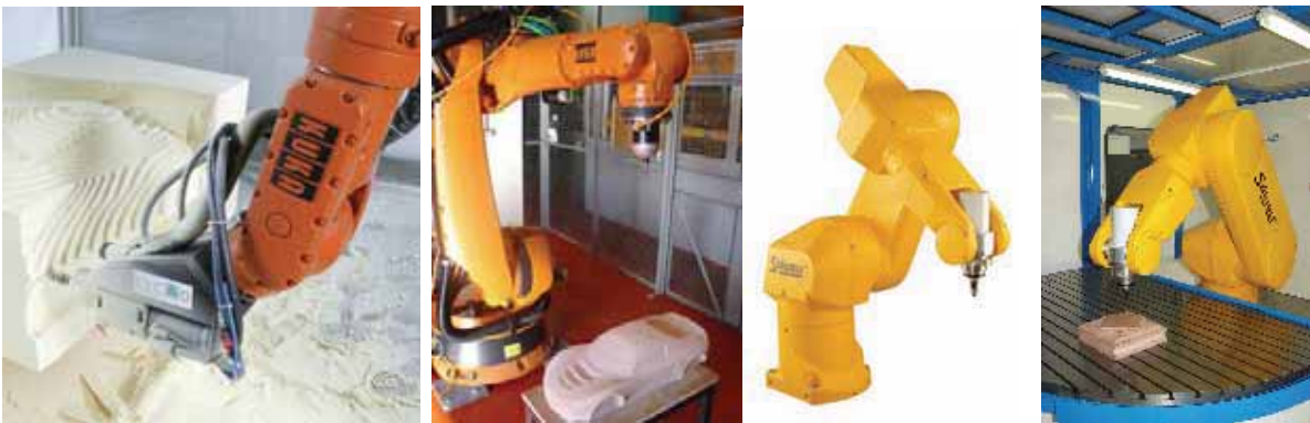
Sl.1 Primeri robota za obradu proizvođača robota KUKA i Staubli
