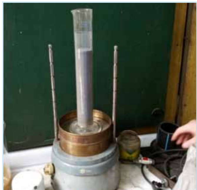
Slika 1. Aparatura za određivanje b) nasipne gustine u zbijenom stanju
