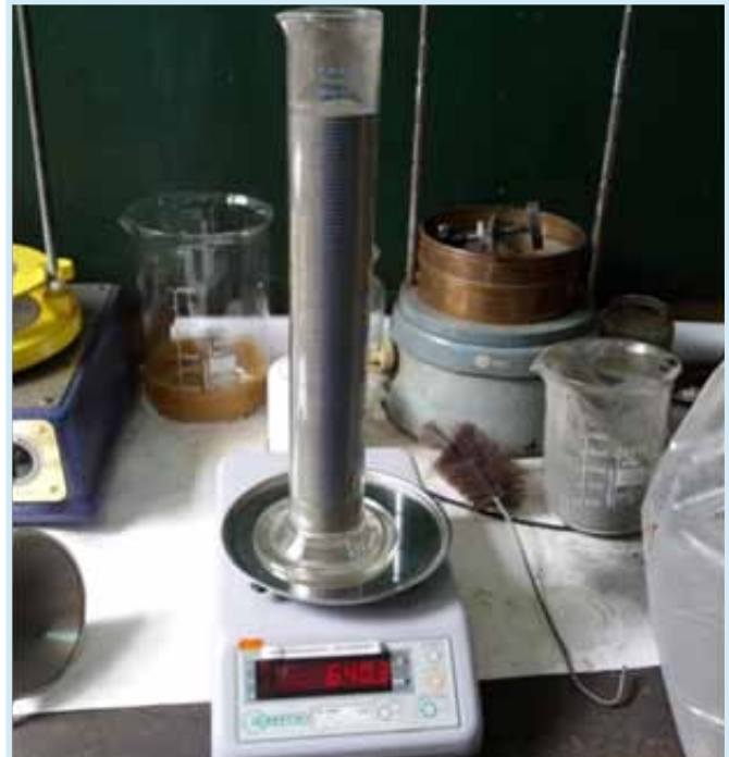
Slika 1. Aparatura za određivanje a) nasipne (zapremnske) gustine
