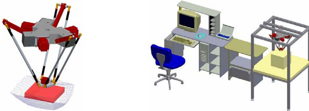
Slika 2. CAD model prototipa prvog domaćeg DELTA robota
