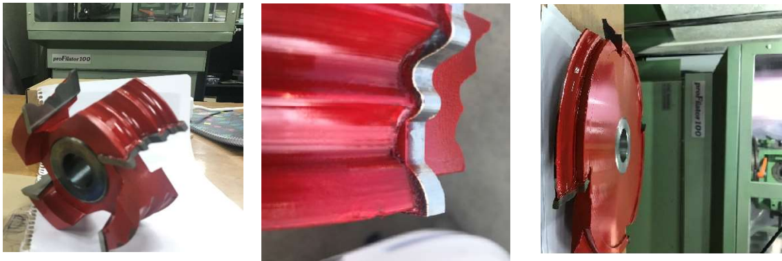
Slika 9. Primeri napravljenih koturastih profilnih glodala na novoj 3+2 osnoj CNC brusilici Profilator 100
