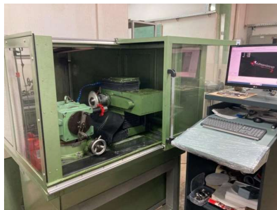
Slika 4. Model i prototip nove CNC brusilice za 3+2 osno brušenje Proficator 100
