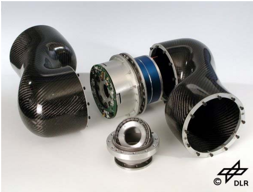
Slika 8: Primer noseće strukture DLR industrijskog humanoida sa jediničnom specifičnom nosivošću. Smanjenje svakog grama potrošenog na noseću strukturu robota povećava masu korisnog tereta kojim robot može da manipuliše (priroda se takodje ne razbacuje materijalom, već restriktivnim optimizacionim mehanizmima ostvaruje visoke specifične performanse).
