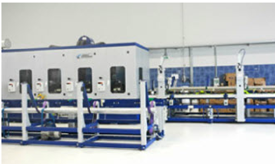
Slika 2: Mašina za brušenje i poliranje okruglih prohromskih cevi
