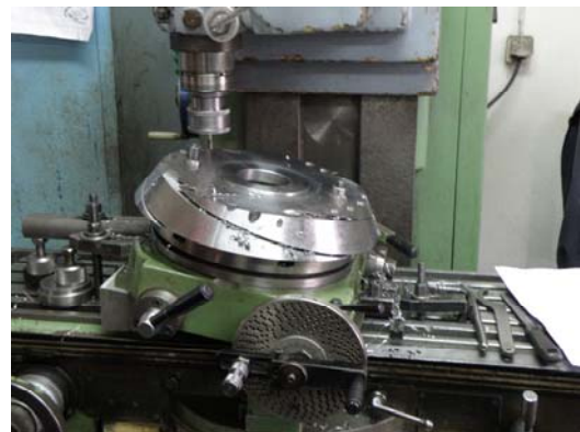
Slika 6. Deo operacije glodanja pri izradi tela drobljača na univerzalnoj glodalici
