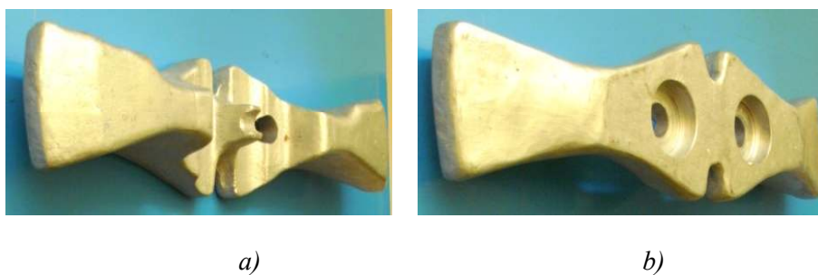
Slika 9. a,b) Završen odlivak papuče grabuljastog transportera
