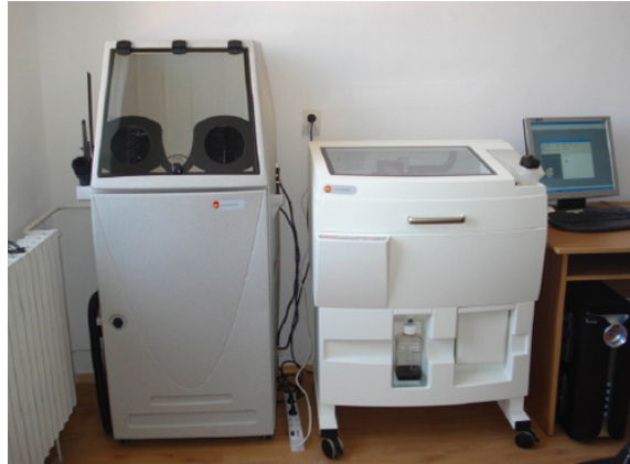
Slika 8. Rapid Prototyping 3D Zcorp 310 sistem za vođenje i štampanje
