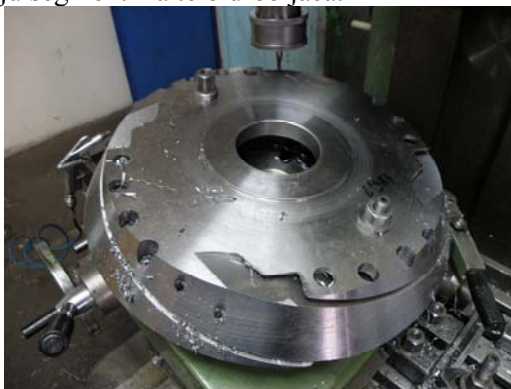
Slika 6. Deo operacije glodanja pri izradi tela drobljača na univerzalnoj glodalici
