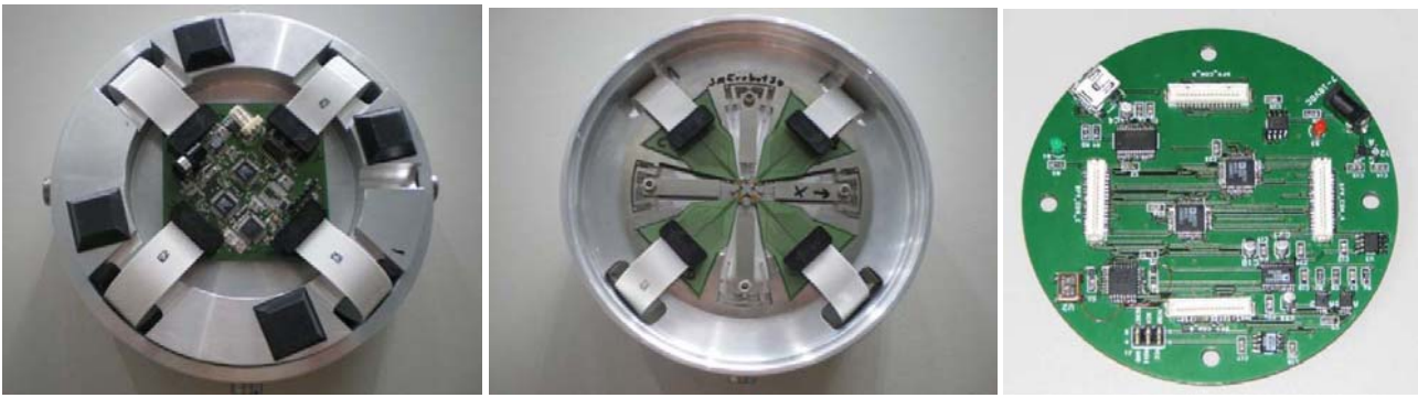
Slika 2: Primeri šestokomponentnog senzora MEMS tehnologije razvijenog u okviru SMErobot projekta za potrebe čovek-robot interakcija/interfejs, sa ključnim performansama: ekstremna kompaktnost, mala masa i jeftina konstrukcija prilagođena masovnoj produkciji.
