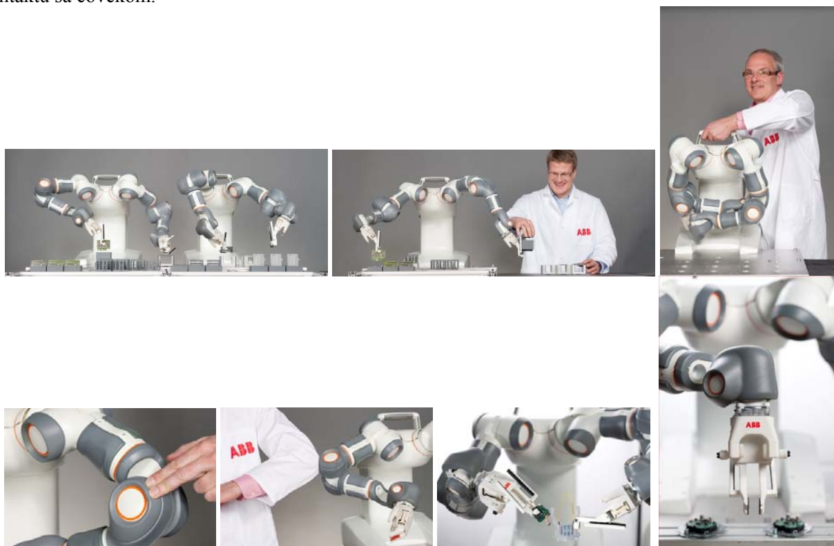
Slika 7: Bimanualni industrijski humanoid FRIDA realizovan za potrebe demonstracionih aktivnosti u okviru FP7 projekta ROSETTA. Robot se sastoji iz razgranate sekvencijalno-paralelne strukture sa ukupno 14 stepeni slobode. Ekstremna redundantnost omogućava mu da jednu ruku koristi kao programabilni pribor, a drugu kao programabilni alat za montažu, čime se suštinski približava modelu funkcionisanja čoveka. Mala masa, proporcije čoveka i drugi oblici zaštite, omogućavaju mu da nesmetano deli radni prostor sa čovekom na proizvodnim linijama za montažu.
