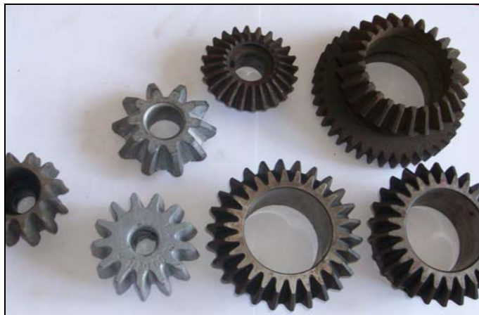
Slika 1: Različiti oblici konusnih zupčastih parova sa pravim zupcima
