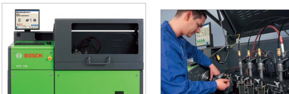
Slika 3. Ispitna oprema sa elektronskim meračima protoka EPS 708
