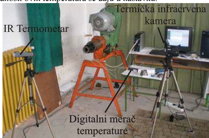
Slika 2. Eksperimentalni štand sa instrumentacijom za merenje
