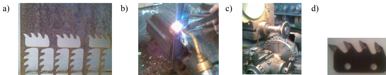
Slika 7. a) ostatak manganske ploče nakon operacije sečenja vodenim mlazom, b) lemljenje pločice od tvrdog metala na telo segmenta, c) oštrenje, d) izgled gotovog segmenta
