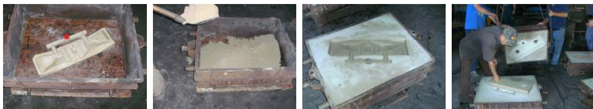
Slika 8. Postupak livenja papuče grabuljastog transportera.
