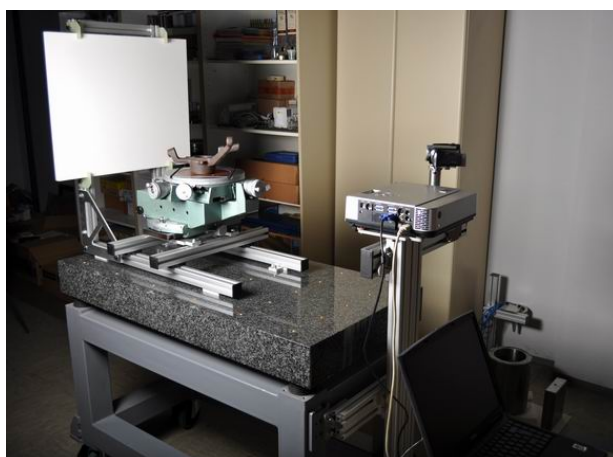
Slika 3.4 Eksperimentalna instalacija za optičku triangulaciju strukturanom svetlošću - verifikacija
