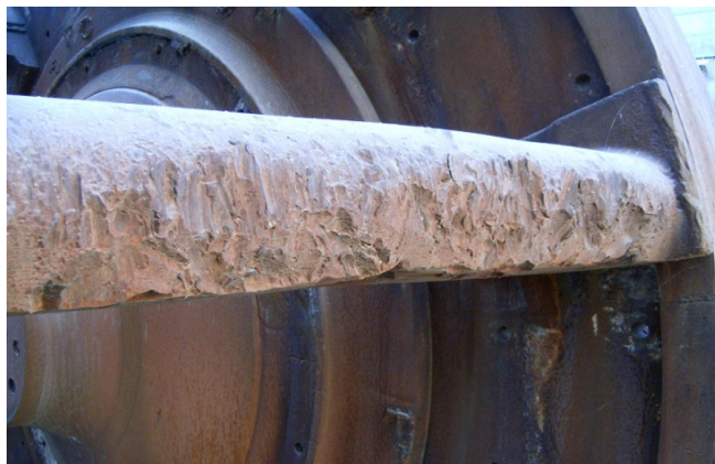
Slika 3. Izgled pohabane udarne ploče
