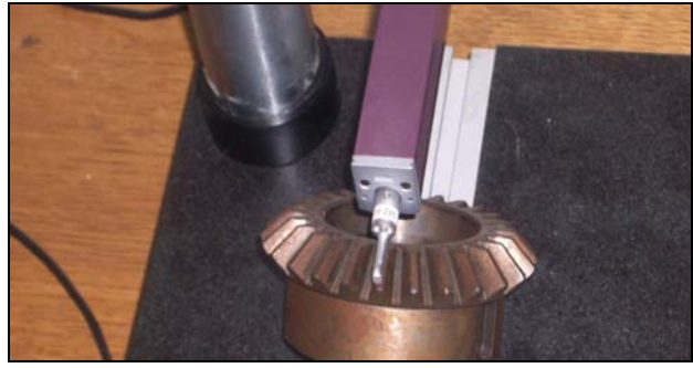
Slika 4: Postupak ispitivanja bokova zubaca (rupičenje) kod konusnih zupčanika sa pravim zupcima
