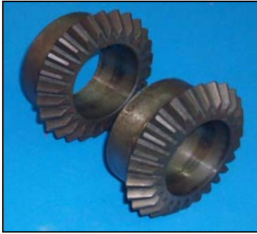
Slika 3: Konusni zupčanici sa pravim zupcima koji su ispitivani Ds 126/2 – 40,58 (mm)
