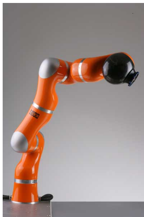
Slika 4: Industrijski humanoid DLR / KUKA LWR – Redundantna antropomorfna zglobna ruka sa 7 stepeni slobode i upravljanja po poziciji, sili i impedansi. Odnos mase i nosivosti 1:1. Mala ukupna masa od samo 14 kg za dohvata od 936 mm obezbeđuje istinsku bezbednost po čoveka u kooperativnom radu.
