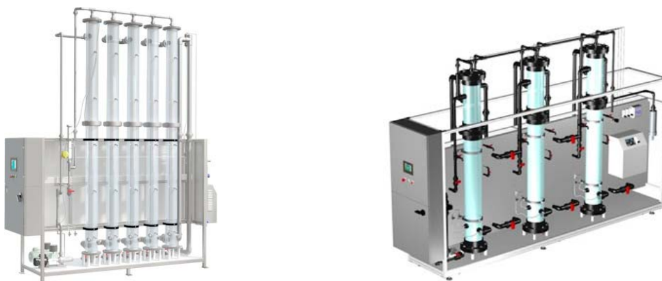
Slika 3. Laboratorijska postrojenja za tretman vode sa kolonama od polivinil hlorida
