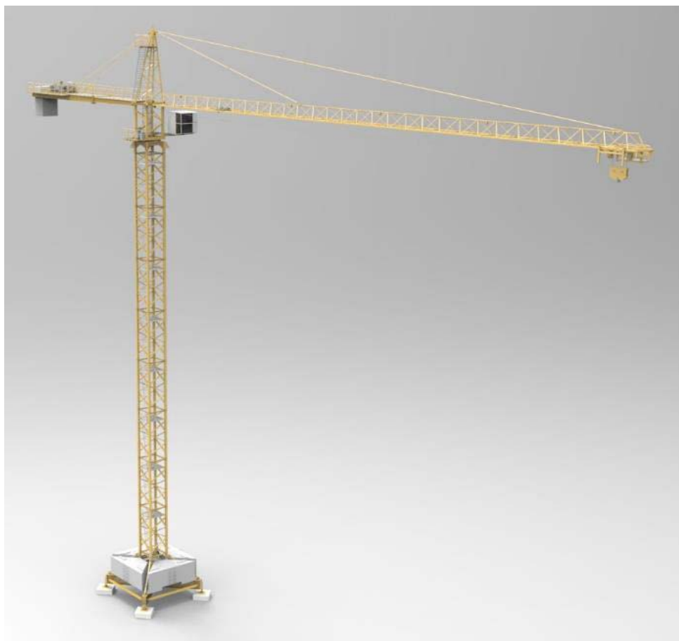
Slika 2. Renderovan model građevinske stubne dizalice
