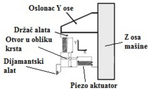
Slika 8. Šematski prikaz 2D ne-rezonantnog VAM sistema [8].
