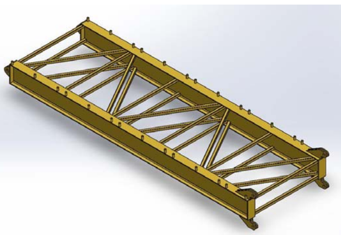
Slika 6. Kraća sekcija kontrastrele
