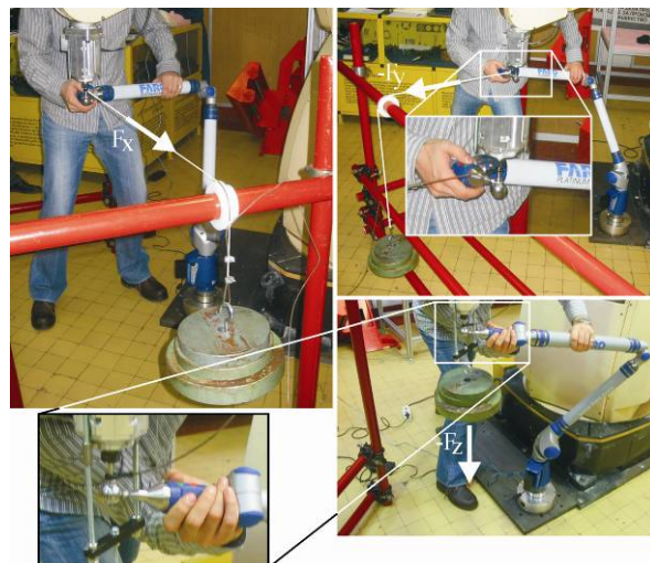
Slika 2. Merenje pomeraja vrha robota u sva tri Dekartova pravca
