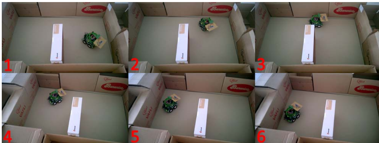
Slika 8. Rezultati eksperimenta – mobilni robot uspešno zaobilazi prepreku primenom upravljanja na bazi veštačkih neuronskih mreža, primenom dvoslojne BR mreže, sa 8 neurona u prvom i 4 neurona u drugom skrivenom sloju.
