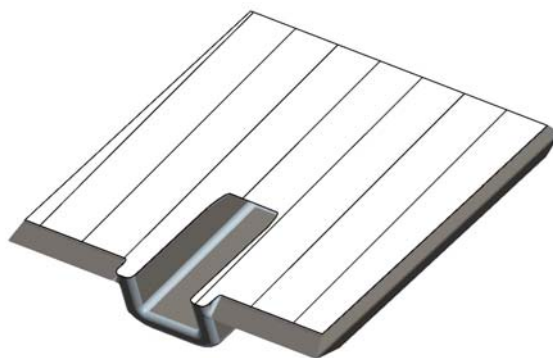
Slika 3. Poprečni presek odlivka A_i(52mm) = 78041.27mm^2
