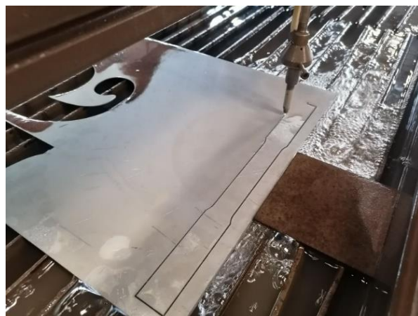
Slika 6. Izrada epruveta vodenim mlazom
