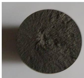
Slika 3. Izgled prelomne površine
