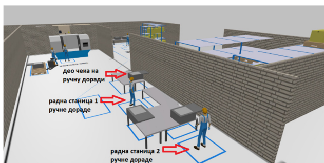
Слика 7. Примери технолошких операција у производњи судопера: а) палетирање, б) CNC обрада, в) ручна дорада, г) палетирање готових производа и припрема за транспорт.
