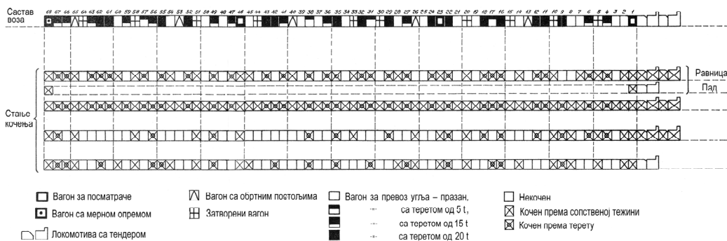
Слика 5. Састав и кочење композиције А 2
