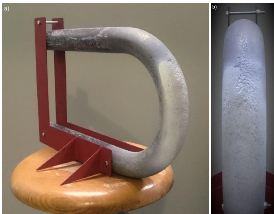
Slika 5. Teme cevnog luka pričvršćenog na držač: a) fotografija stohastične šare; b) krateri i hrapavost na temenu cevnog luka kao posledica gasne korozije
