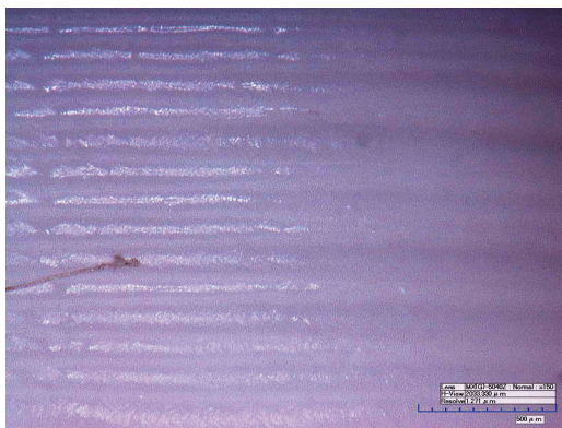
Fig.13. PLA plastic, layer thickness 0,1 mm
