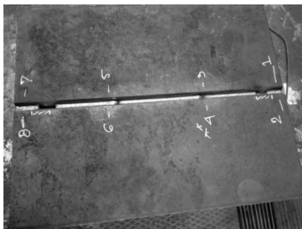
Figure 3. Root run with deliberately made imperfections Slika 3. Koreni zavar sa namerno napravljenim greškama
