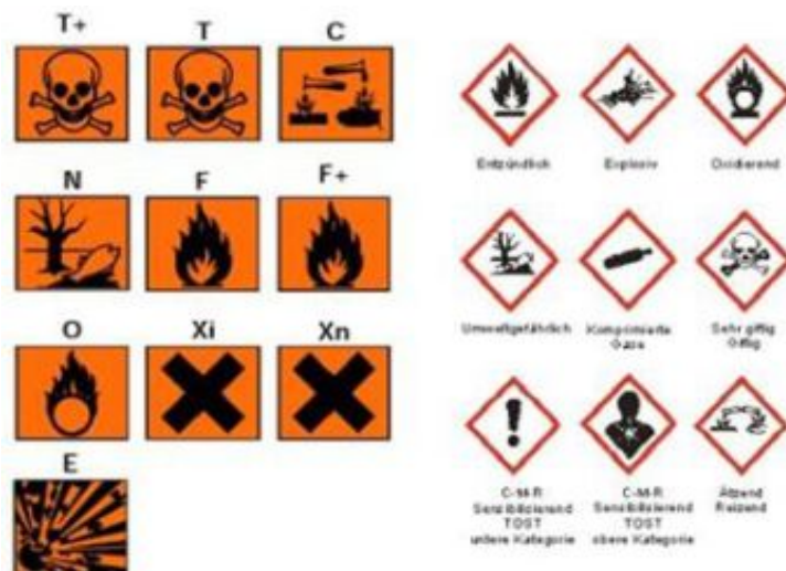
Slika 1. Piktogrami za pojedine opasne fluide, a) korišćeni u PED 97/23/E; b) koji se koriste u PED 2014/68/EU
