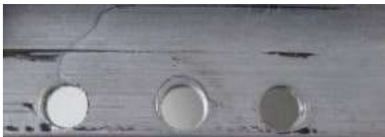
Slika 7 - Konačan izgled prve prsline
