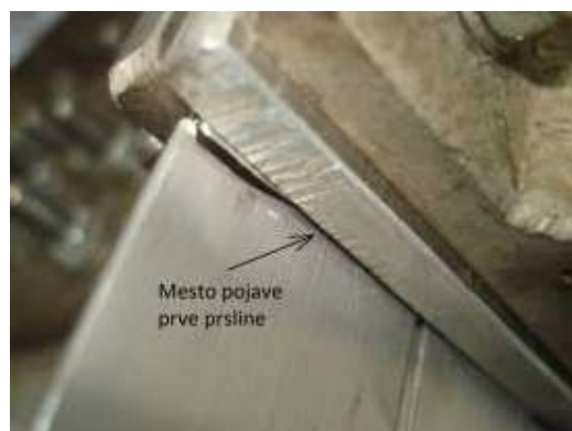
Slika 5 - Mesto iniciranja prve prsline
