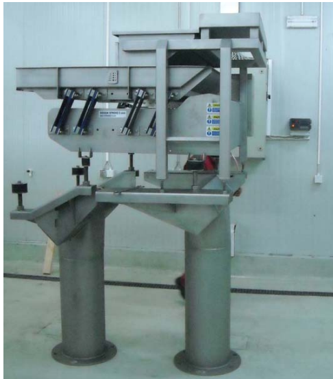
Slika 1. Platforma za prihvatanje smrznutog voća, prijemni koš sa zasunom i vibracioni dodavač-dozator
