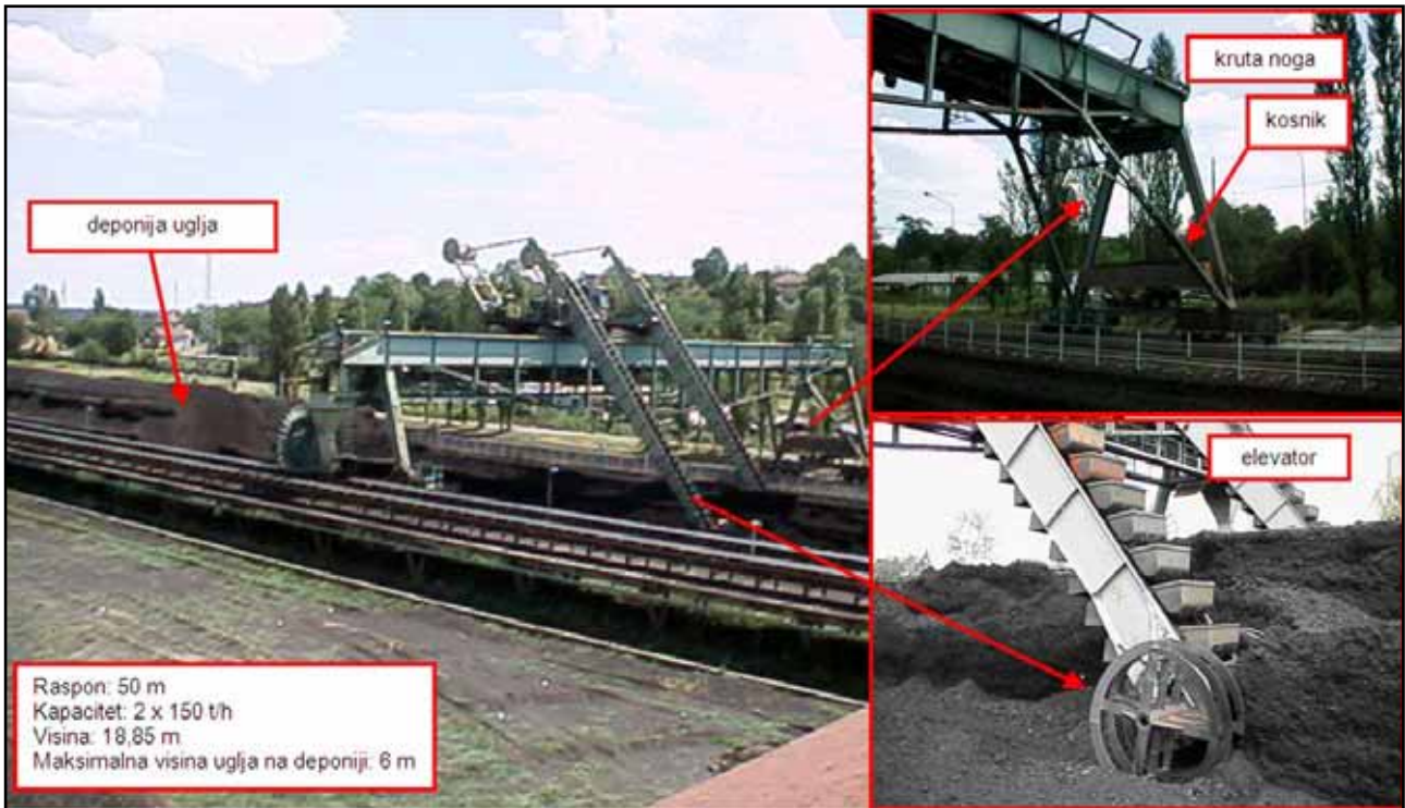
Slika 25. Pretovarni most za uglj Metalna 300 – detalji krute noge i zahvatnog uređaja
