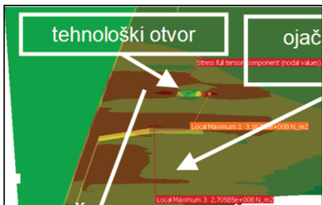
Slika 21. Detalj polja napona u kritičnoj zoni, \sigma_{x,max}=32,1 \text{ kN/cm}^2
