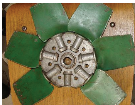
Слика 3.21 Изглед обртног кола вентилатора у основној равни приликом скидања једне лопатице за скенирање.
