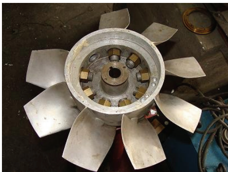
Слика 3.22 Изглед потисне стране обртног кола са једном уклоњеном лопатицом за 3Д скенирање.
