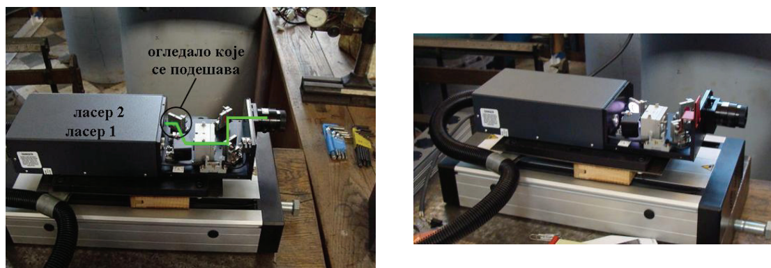
Слика 4.29 а) Изглед ласера и оптике која се подешава; б) Ласер у раду са постављеним интерлоком.
