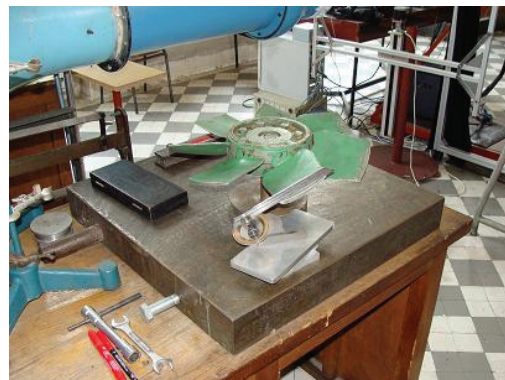
Слика 3.17 Подешавање угла лопатица контролом на пречнику D_a .
