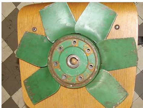
Слика 3.21 Изглед обртног кола вентилатора у основној равни приликом скидања једне лопатице за скенирање.
