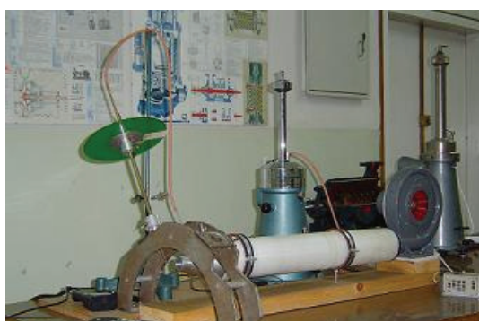
Слика 4.12 а) Калибрација аеротунела у различитим правцима; б) калибрација малог аеротунела пре почетка калибрације модификоване сонде.
