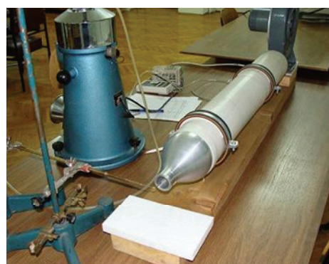
Слика 4.12 а) Калибрација аеротунела у различитим правцима; б) калибрација малог аеротунела пре почетка калибрације модификоване сонде.
