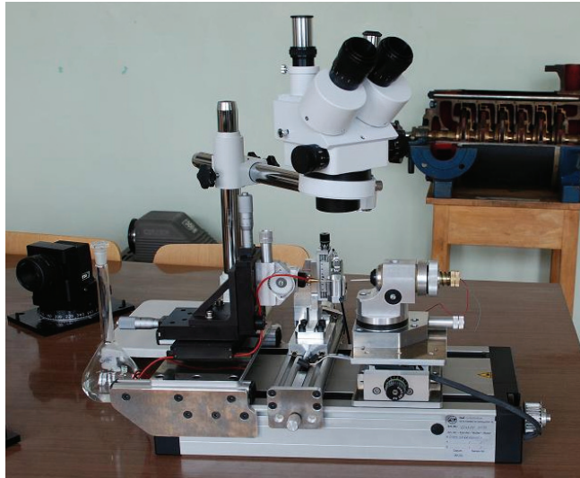
Слика 3.8 Уређај за репарацију мерних сонди у радној позицији са стерео микроскопом.
