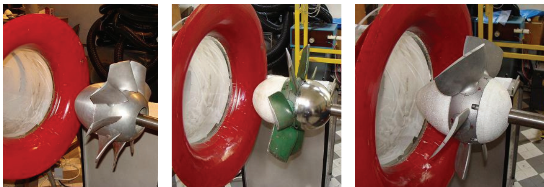
Слика 3.18 Монтирана обртна кола на вратилу типа ЗП, W и SP, редом.
