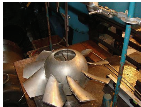
Слика 3.23 Снимање димензија главчине кола.
