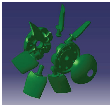
Слика 3.20 3Д модел Woods-овог обртног кола.
