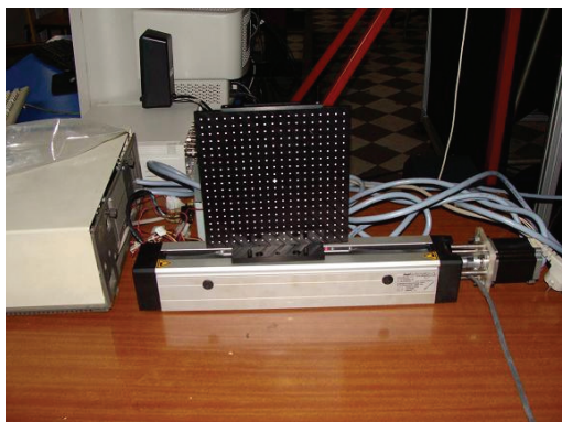
Слика 4.38 Могућности позиционирања мете у односу на ласерски сноп за снимање у вертикалној меридијанској равни.
