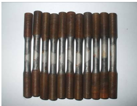
Slika 6.20. Epruvete zavarenog spoja NN-70 spremne za ispitivanje NCZ
