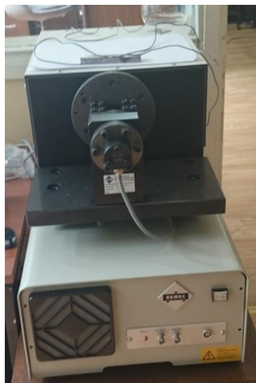
Slika 6.40. Cractronic pulzator za stvaranje zamorne prsline
