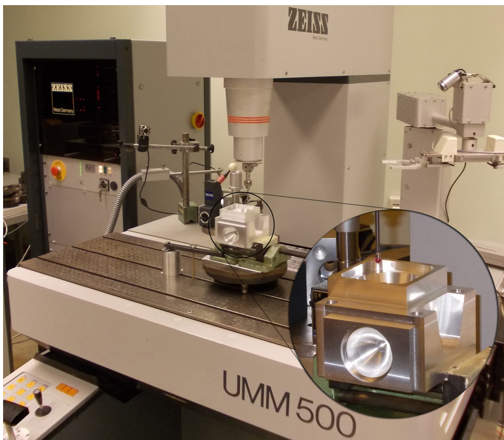
Слика 6.15: Експериментална инсталација за мерење дела бр.2
