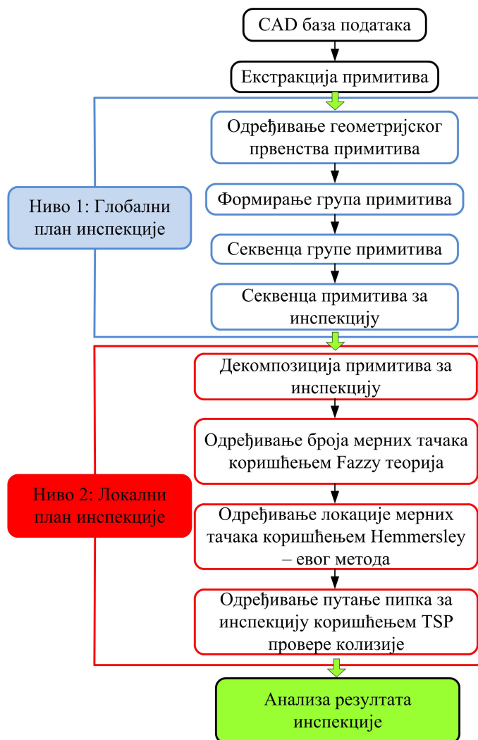
Слика 2.9: Шема "on – machining" мерења [106, 107]
