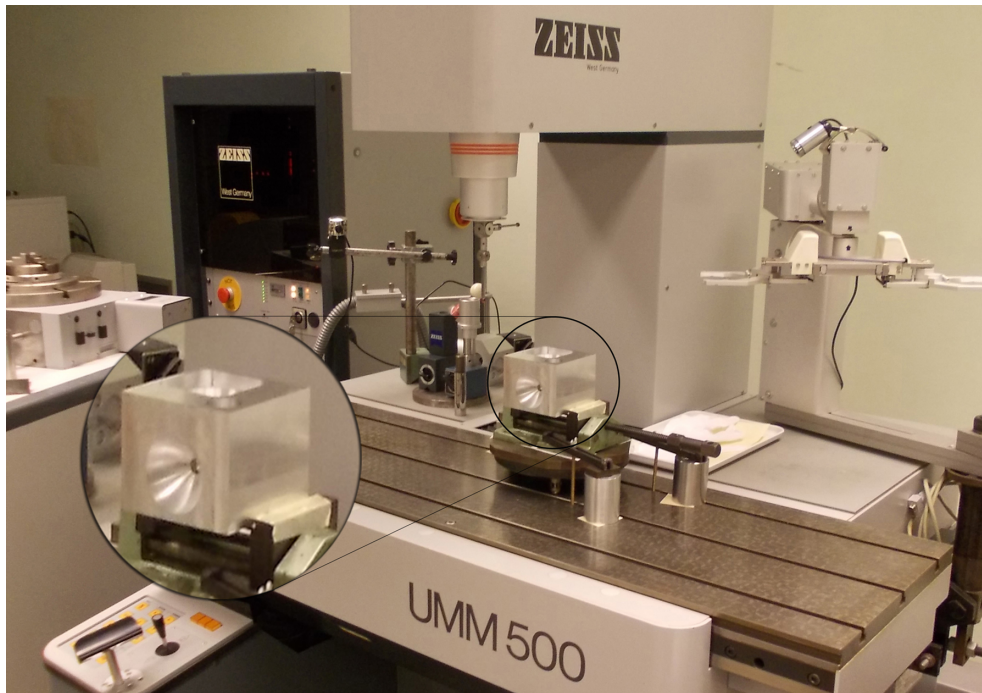
Слика 6.14: Експериментална инсталација за мерење дела бр.1
