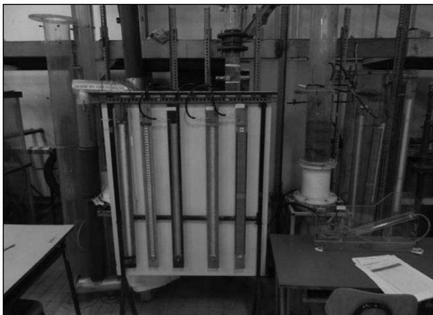
Slika 3. - Instalacija korišćena za ispitivanje fluidizacionih karakteristika nasutog sloja uzorka pepela
