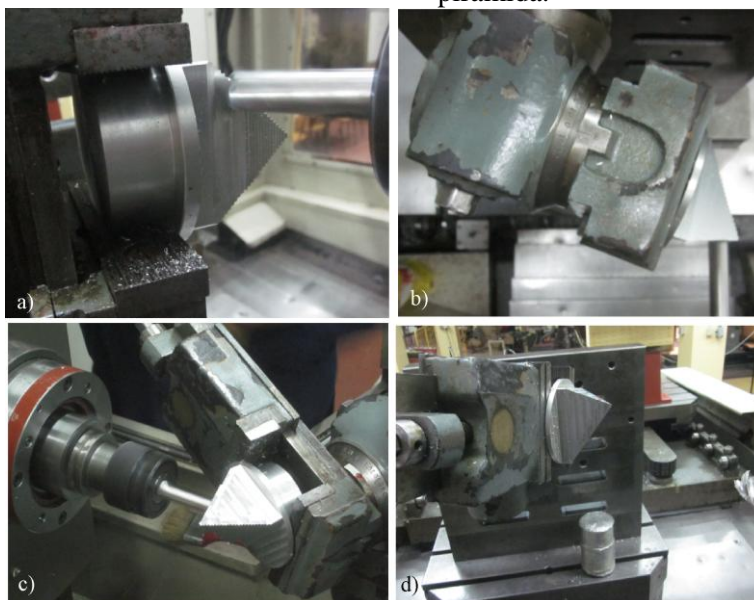
Slika 13. Završna obrada trostrane piramide na mašini LOLA HMC500
